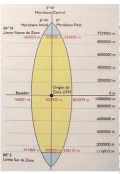
En este sistema se proyectan pequeñas zonas del globo sobre superficies planas, realizando proyecciones sobre un hipotético cilindro transversal que va girando alrededor del eje norte sur. Esto da como resultado unos husos o zonas UTM. Cada huso tiene 6º de anchura en su parte central, ya que la deformación crece a medida que nos alejamos del Ecuador la proyección UTM queda limitada entre los paralelos 84º norte y 80º sur y se complementa con una proyección polar estereográfica.
