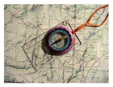
Existen variaciones en el campo magnético. La diferencia de ángulo entre el norte geográfico y magnético varía de un lugar a otro. En el margen del mapa se indica esta desviación con una flecha que señala hacia el norte geográfico y otra que señala hacia el norte magnético. La diferencia de grados entre uno y otro se llama declinación magnética. En España, actualmente, es aproximadamente de 5º NO.
